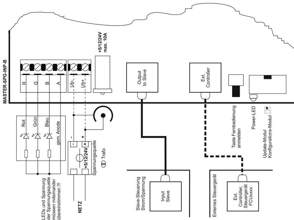
Abb. 1: Anschlussplan Master mit Fernbedienung
